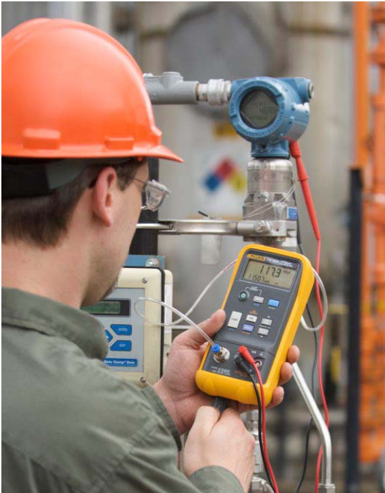
Fluke 719 电动压力校准器
