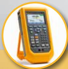
借助新型 729 自动压力校准器，只需按下一个按钮便可轻松生成和控制各测试点的压力。只需输入校准起始压力和终止压力及所需的设置点数量，其余的事情由校准器来完成——根本无需手动泵或手动微调。
