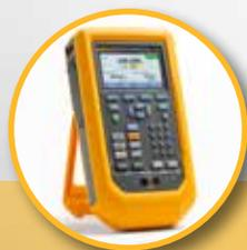
使用新型 **Fluke 729** 自动压力校准器时，内部自动电动泵在测试期间可自动调节压力，无需手动调节。
