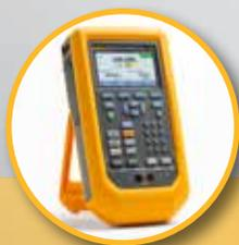
使用 **729** 自动压力校准器测试压力开关时，其可以自动找到并记录开关设置点、复位点和死区，从而节省时间并提供可靠、可重复的结果。
