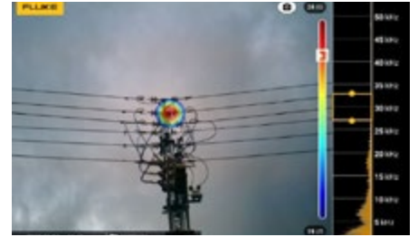
10kv线路的陶瓷横担放电
